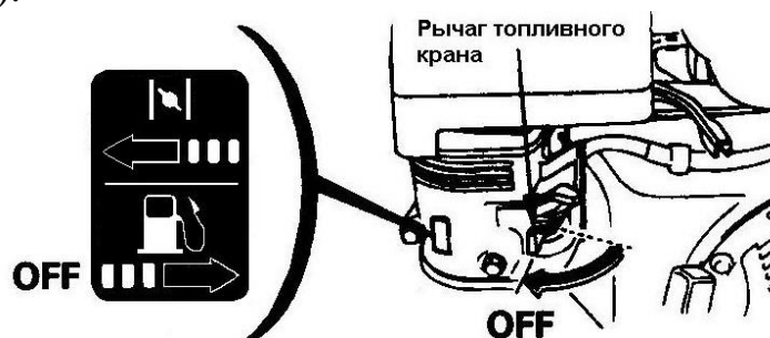
Рисунок 12 – Рычаг топливного крана в положении "OFF" ("Выключено")
