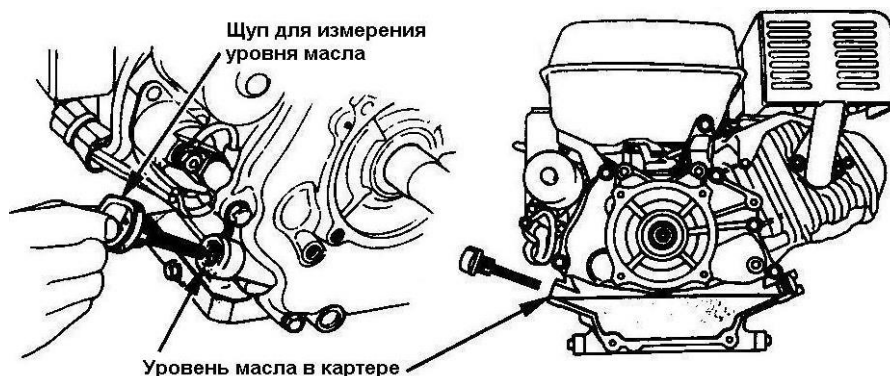
Рисунок 2 – Уровень масла в картере двигателя
