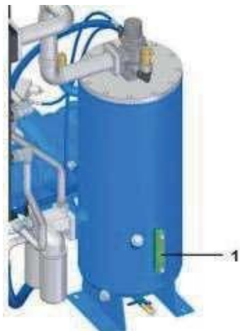
Рис. 31: Проверка уровня компрессорного масла через смотровое стекло
