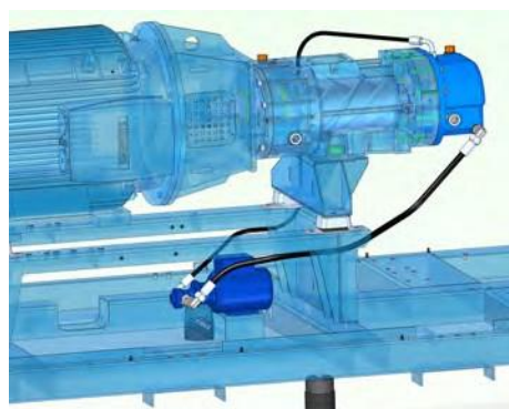
Рис. 16: Насос для смазки редуктора ступени компрессора
